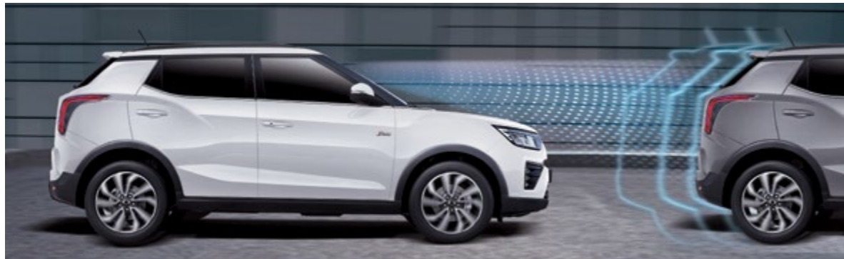
Alert sprawnego ruszania (FVSA). Ostrzega komunikatem wizualnym i alertem dźwiękowym w chwili po tym, jak ruszy pojazd z przodu.
