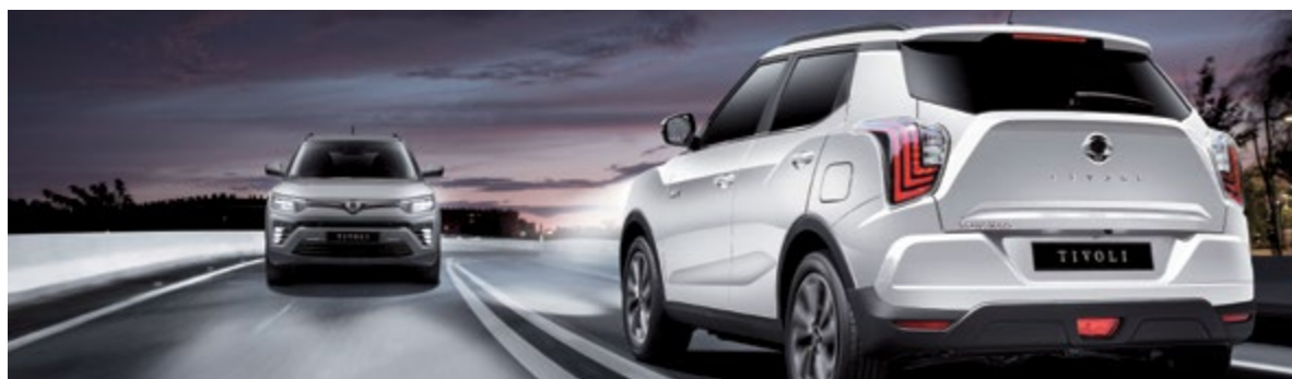
Automatyczne przełączanie świateł mijania/drogowe (HBA). Poprzez monitorowanie reflektorów nadjeżdżających pojazdów i świateł pojazdów poprzedzających, HBA analizuje otoczenie, aby automatycznie przełączać funkcje świateł drogowych i mijania.
